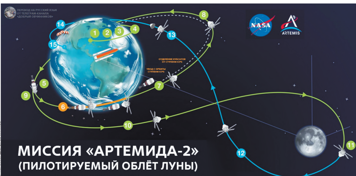
1—3 — запуск, 4 — выход на круговую орбиту, 5 — включение двигателей верхней ступени, 6—7 — отделение корабля, 8 — маневр по увеличению перигея орбиты, 9 — включение основного двигателя «Ориона», 10 — орбитал Луне (3 дня), 11 — облет Луны, 12—15 — возвращение на Землю.
