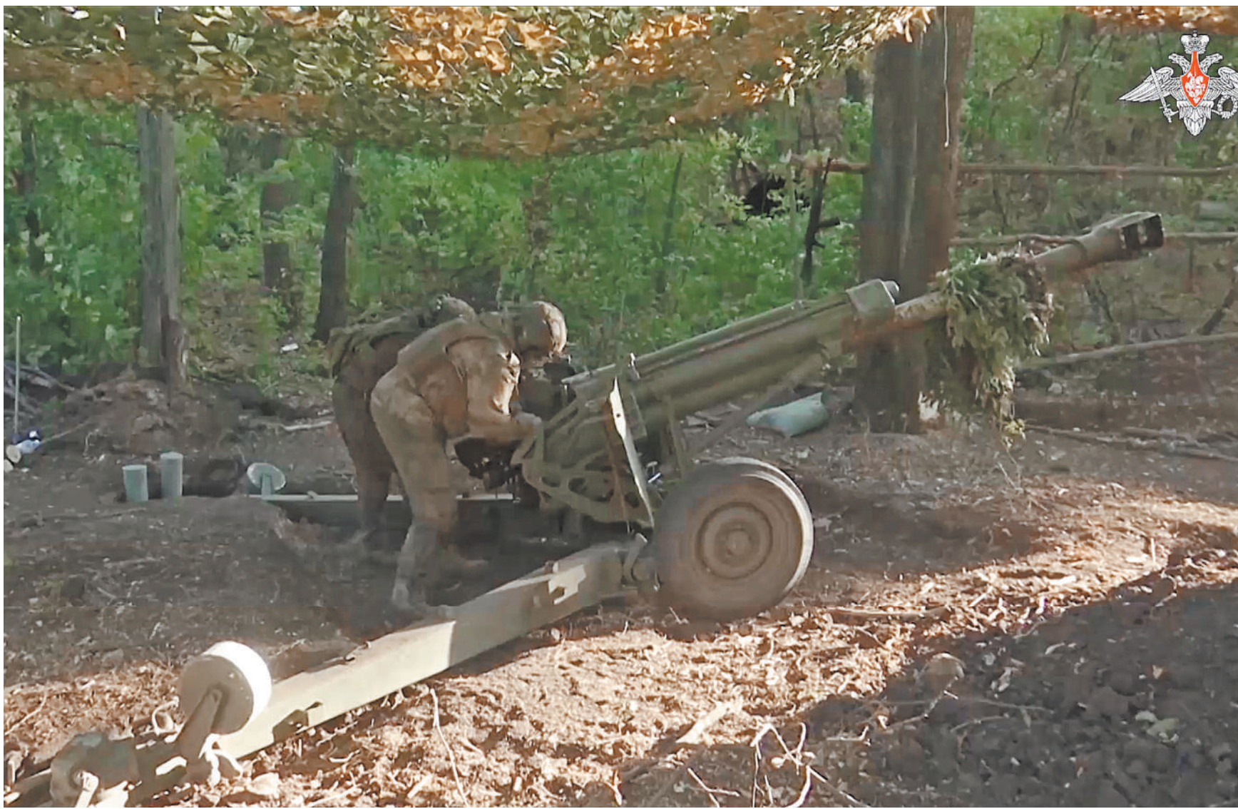
Орудие «Нона-К» сочетает в себе возможности пушки, гаубицы и миномета и способно вести огонь всеми типами 120-мм мин, а также осколочно-фугасными и кумулятивными снарядами.
