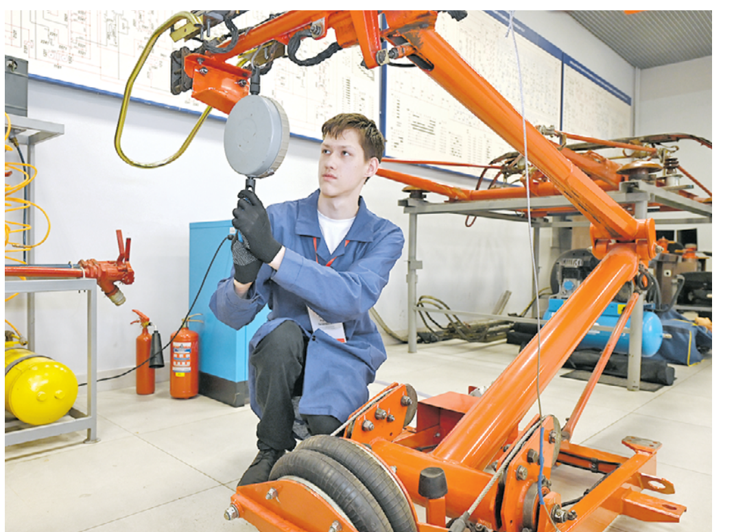
1 апреля. Участник Чемпионата высоких технологий Родион Савосин измеряет изношенность вставки и силу нажатия токоприемника. Фото: АНАТОЛИЙ ЦЫБАЛЮК
